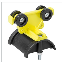
Wózek kablowy plastikowy, szerokość 55 mm, maksymalne obciążenie 15 kg, maksymalna prędkość 50 m/min, 30607011 GG-30607011000000
